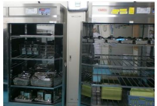
1枚ずつ手洗いした後、洗浄機に入れます。洗浄後は熱風消毒保管庫で、乾燥保管しています。
