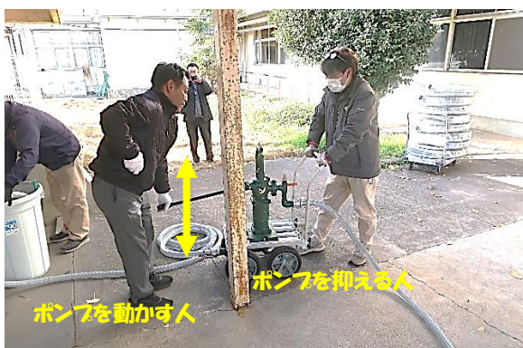
⑧ポンプのレバーを上下に動かし、水をパイプに送り込みます。
