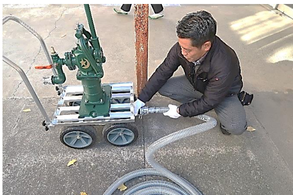
①プールの水をパイプに入れるためのポンプを準備します。(ホースとポンプを接合)
