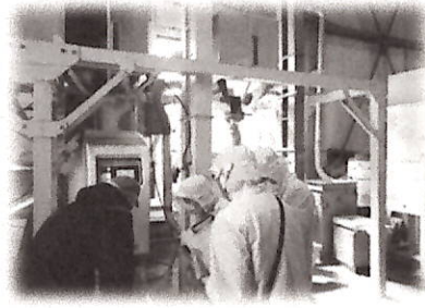
石抜き機～精米機～小米取機～集塵機
